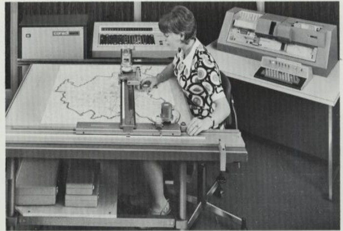
Elektronisches Koordinatenmessgerät «Ortogonal-Digimeter»
