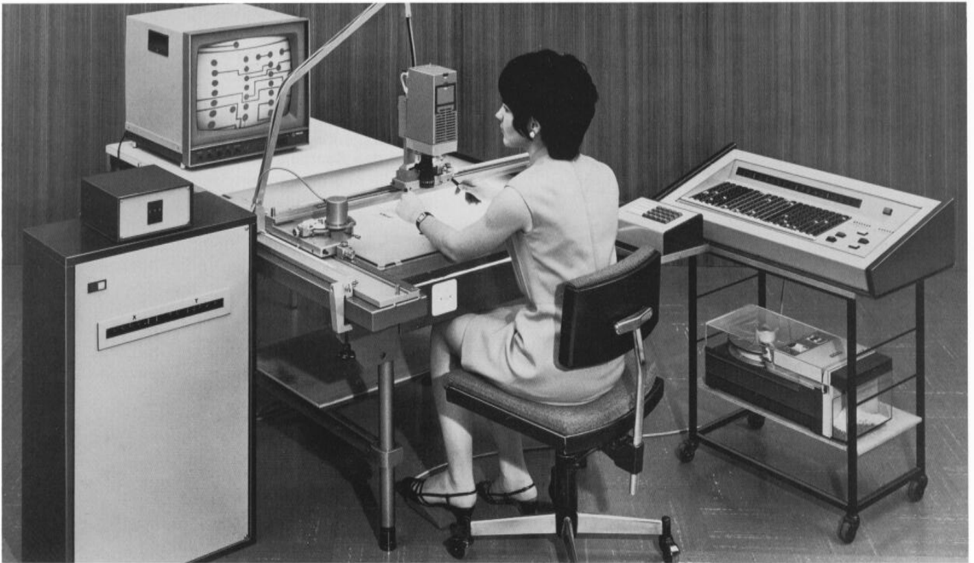
Orthogonal-Digimeter mit technischer Fernsehanlage, Nummernzähler und zusätzlicher Tastatur
