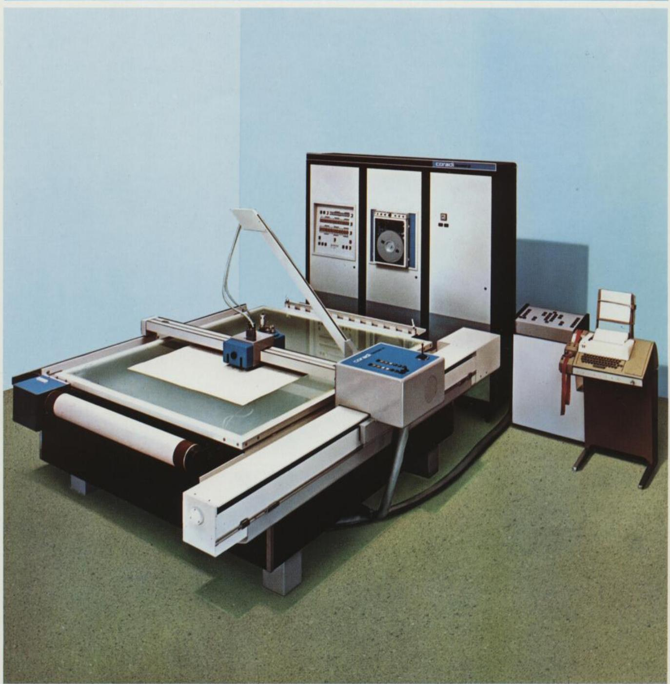
Der CORADOMAT ist ein numerisch gesteuerter Grosskoordinatograph zur automatischen Herstellung präziser Zeichnungen.
