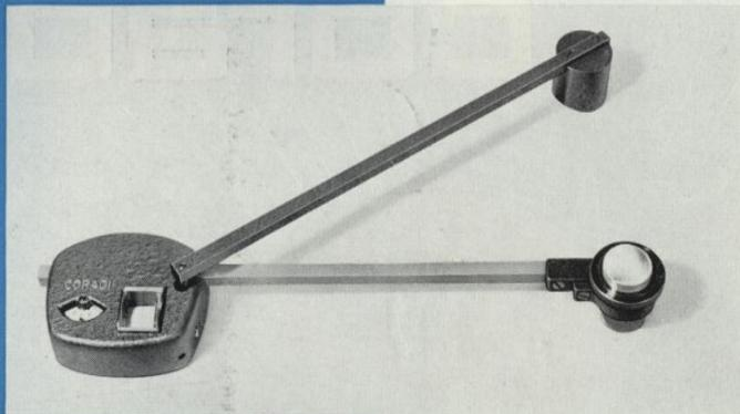
Les planimètres à compensation «CORADI» sont des instruments robustes et précis de mesure des surfaces, destinés aux Cabinets de Géomètres, aux Bureaux d'Etudes et aux Laboratoires Scientifiques. Erreur maximum de mesure 0,2%, capacité de contournement  $\varnothing$  720 mm.
