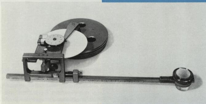
Scheibenpolarplanimeter für das Messen kleinerer Flächen. Arbeitsbereich  $R_i = 245$  mm,  $R_a = 445$  mm, lieferbar mit Fahrlupe oder Fahrstift.
