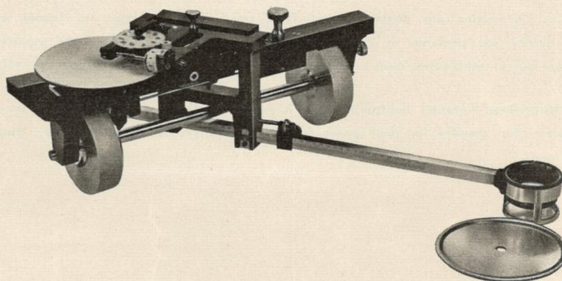
L'instrument couvre une largeur maximum selon la longueur correspondante de la tige motrice, au total 30 cm, mouvement longitudinal illimité.
